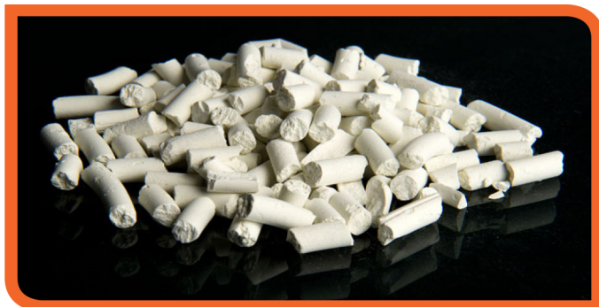
شکل ۱. جاذب سولفورزدائی اکسید روی رابطه ۳ ZnO + H_2S \rightarrow ZnS + H_2O
