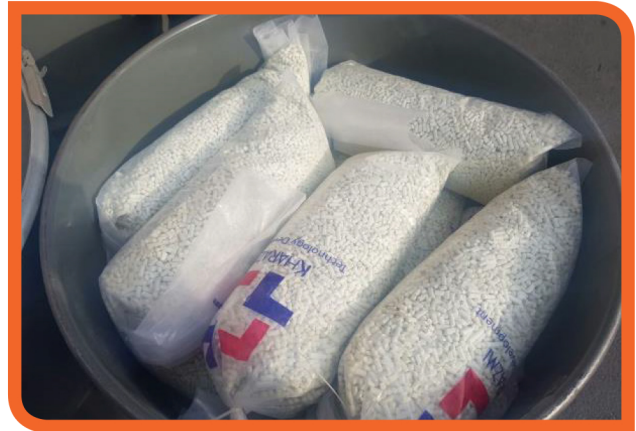
شکل ۲. جاذب های تولیدی و بسته بندی شده سولفورزدائی اکسید روی شرکت گسترش فناوری خوارزمی
