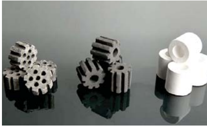
تصویر کاتالیست خشی (سمت راست)، نیمه فعال (وسط) و فعال (سمت چپ) مورد استفاده در ریفرم مدول ۱ شرکت فولاد خوزستان
