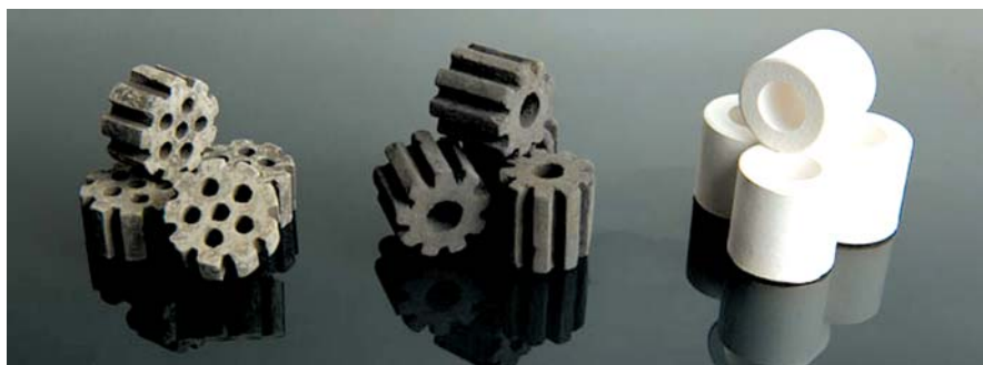
تصویر کاتالیست خنثی (راست)، نیمه‌فعال (وسط) و فعال (سمت چپ) مورد استفاده در ریفرم مدول ۱ شرکت فولاد خوزستان
