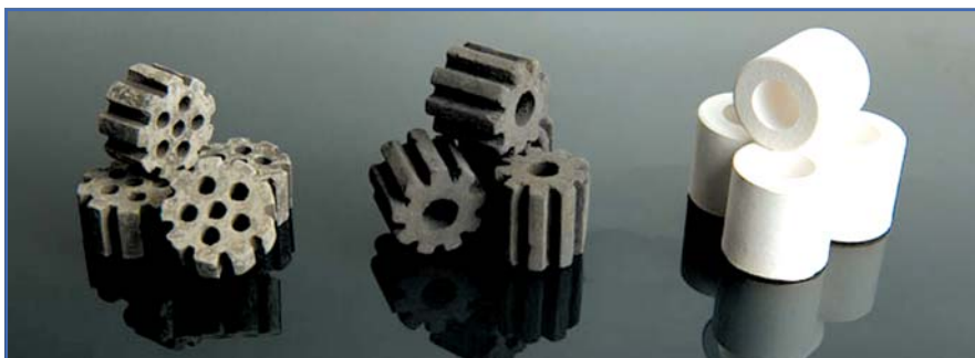
تصویر کاتالیست ختنی (راست)، نیمه‌فعال (وسط) و فعال (سمت چپ) مورد استفاده در ریفرمر مدول ۱ شرکت فولاد خوزستان
